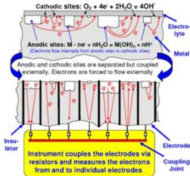
최근 POSCO는 새로 개발한 신소재 POPSMAC 소재(탄소강 표면에 3원 도장 처리)의 우수한 내식성을 홍보하기 위해 미국 Corr. Instrument 사의 On Line Monitoring 시스템을 장착해서 부식 실험을 예정 중에 있습니다. Corr. 사의 probe는 내부에 전극을 9개 심어서, 플랜트 설비의 local corrosion을 검출하는데 아주 효과적입니다. (부식이 전기화학 반응이므로, 국부적인 산화 환원 반응이 일어나면 9개의
